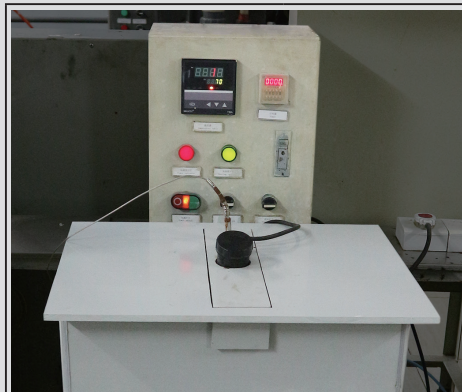
Baño de prueba con hipoclorito de sodio
