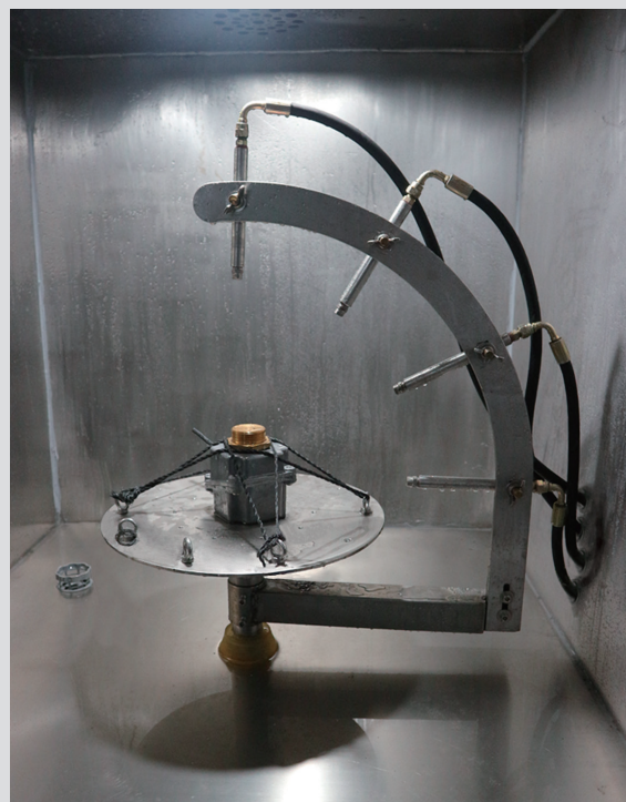
Carcasa durante la prueba IPx9k
