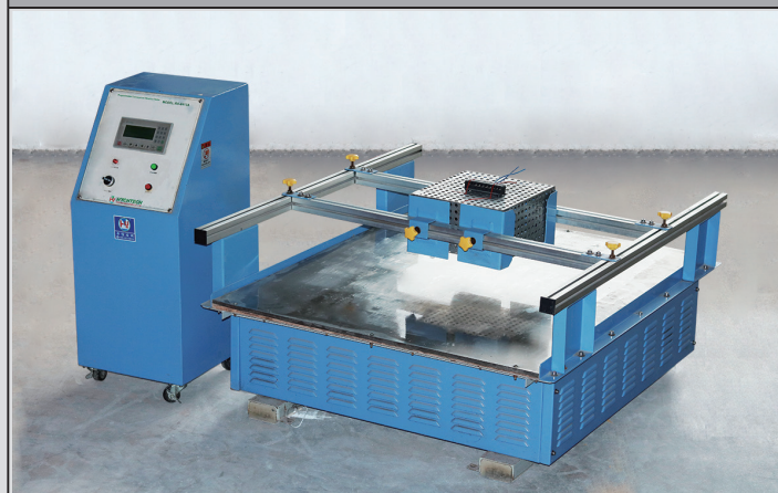
Equipo de prueba de vibración
